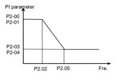
Figure 6-2 PI parameter diagram
