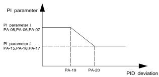
Figure 6-25 PID parameter switching diagram
